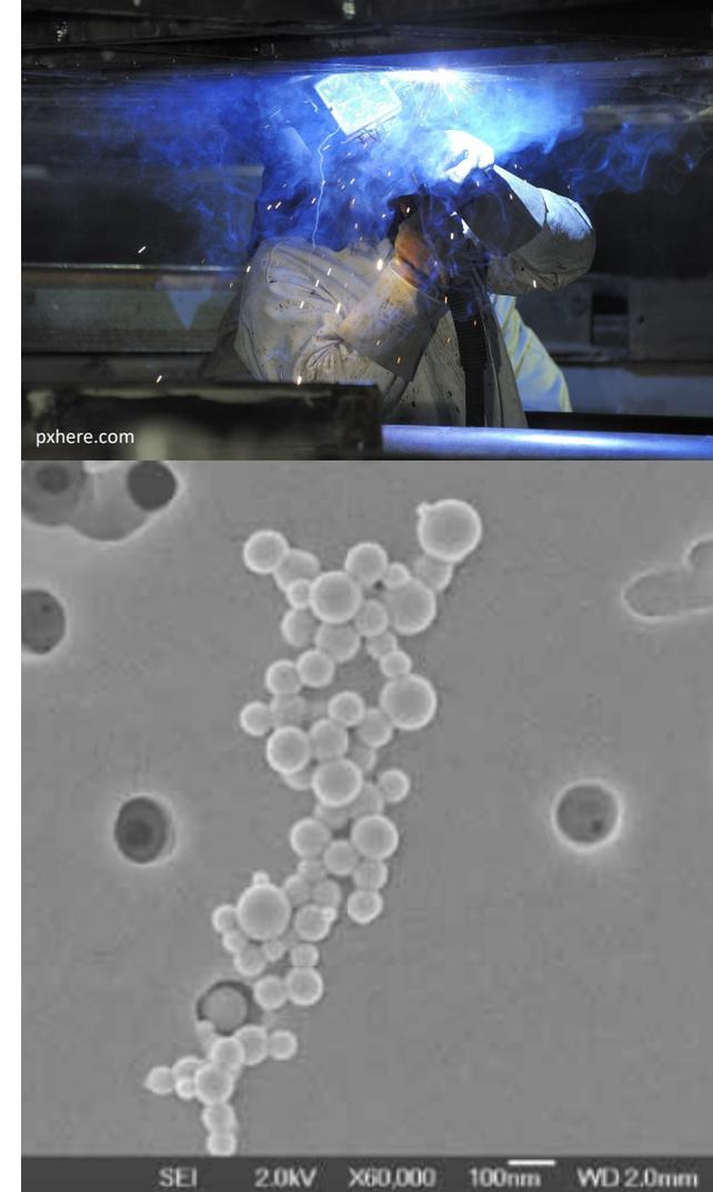
Fumées de soudage par microscope électronique à balayage (source: INRS ED 6132)
